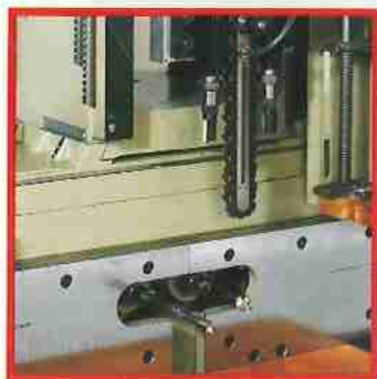
Catena con mandrini verticali e punte orizzontali Chaîne avec mandrins verticaux et mèches horizontales. Kette mit Vertikalspindeln und Horizontalbohrer. Chain with vertical spindles and horizontal bits.
